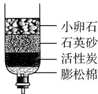
①村民将浑浊的坑水用如图所示的简易净水器进行净化,其中石英砂起 \_\_\_\_\_作用;这种分离过程属于 \_\_\_\_\_(填“物理变化”或“化学变化”)。
